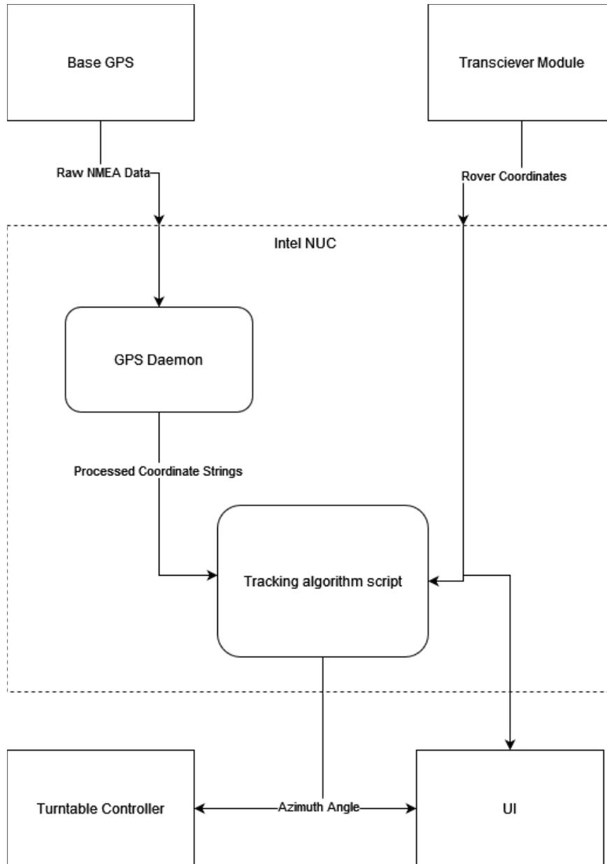
Fig. 4.1.3.2: Full Tracking Subsystem Diagram
